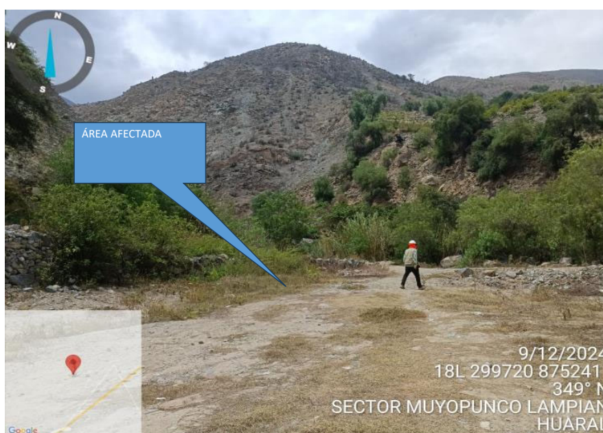
FIGURA N°03: EN LA TEMPORADA DE MAXIMAS AVENIDAS, LA QUEBRADA MUYOPUNCO SE SEDIMENTA Y REALIZA DESVIO DE AGUAS OCACIONANDO, DETERIORO DE LA CARRETERA.
